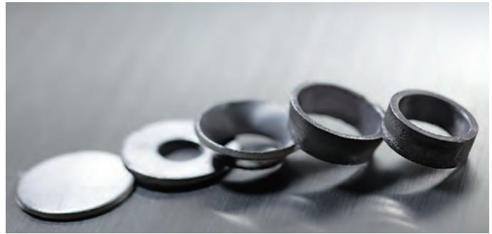
鍛造による成形方法。左から右へいくにつれ、丸くくり抜いた板材が立体のリング状になる。
